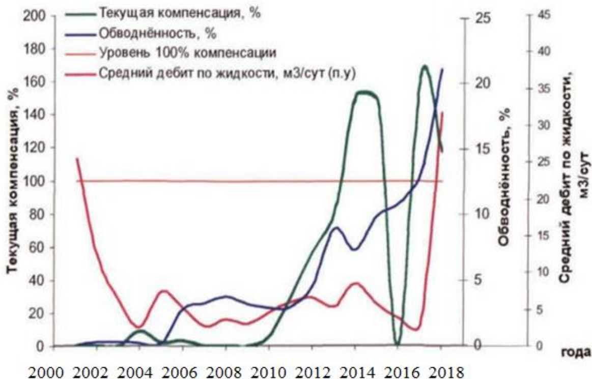
Рисунок 3.12 - Влияние системы ППД на дебиты жидкости и обводненность продукции добывающих скважин
